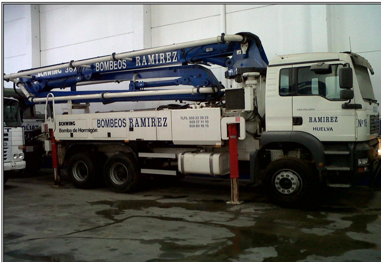
Autobomba de hormigonar marca Schwing modelo P-2023 HDRM KVM 34x, sobre camión Man modelo TGA con 360cv de potencia.
