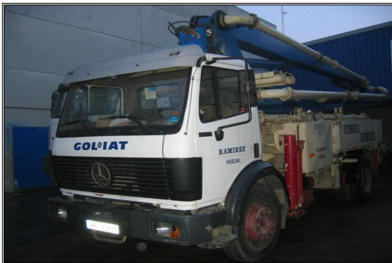
Autobomba de hormigonar marca Schwing modelo BPL-900-HD KVM 28, sobre camión Mercedes-Benz modelo 2225-B con 300cv de potencia.
