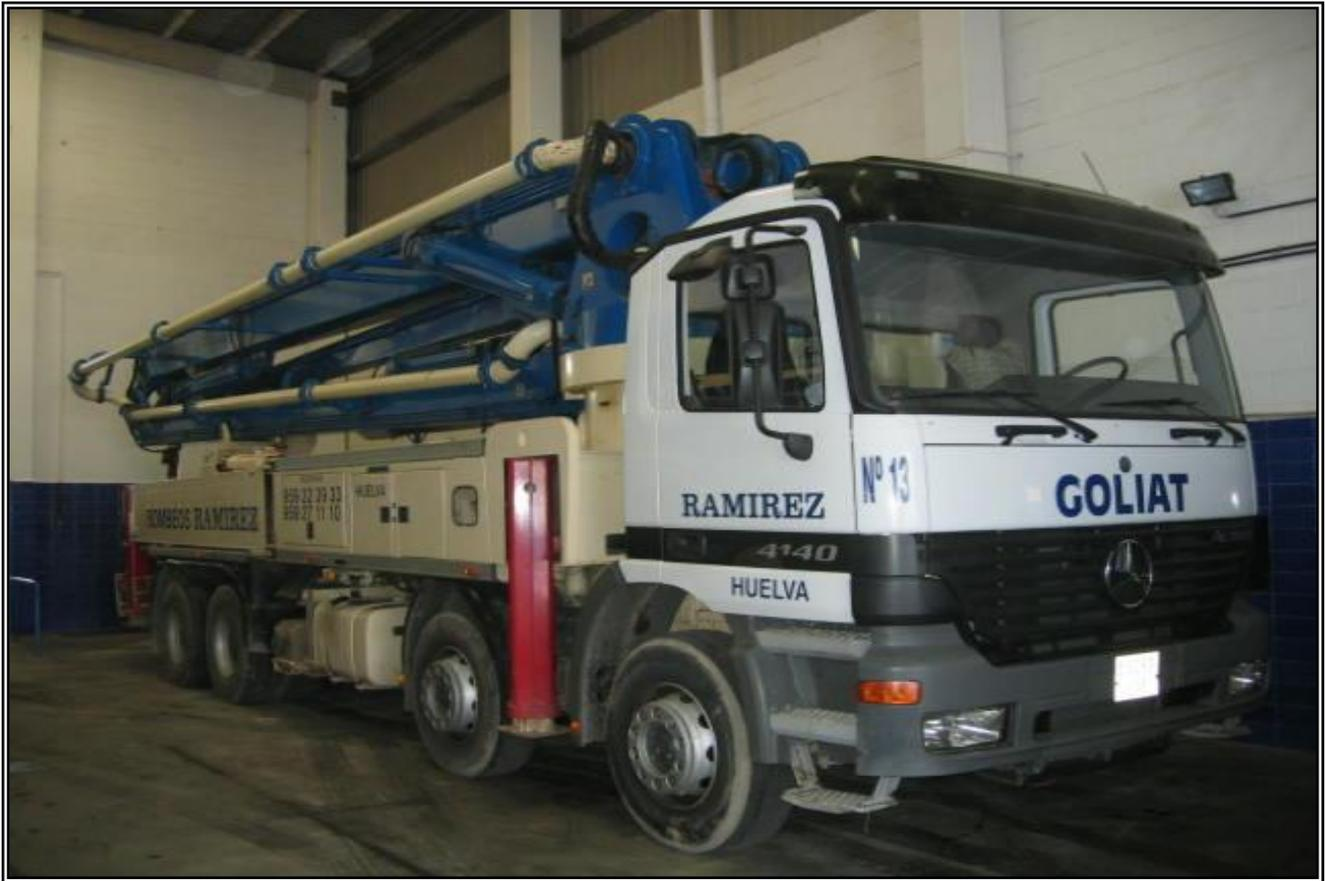
Autobomba de hormigonar marca Schwing modelo P-2023 H-KVM 42SX, sobre camión Mercedes-Benz modelo 4140 con 404cv de potencia.
