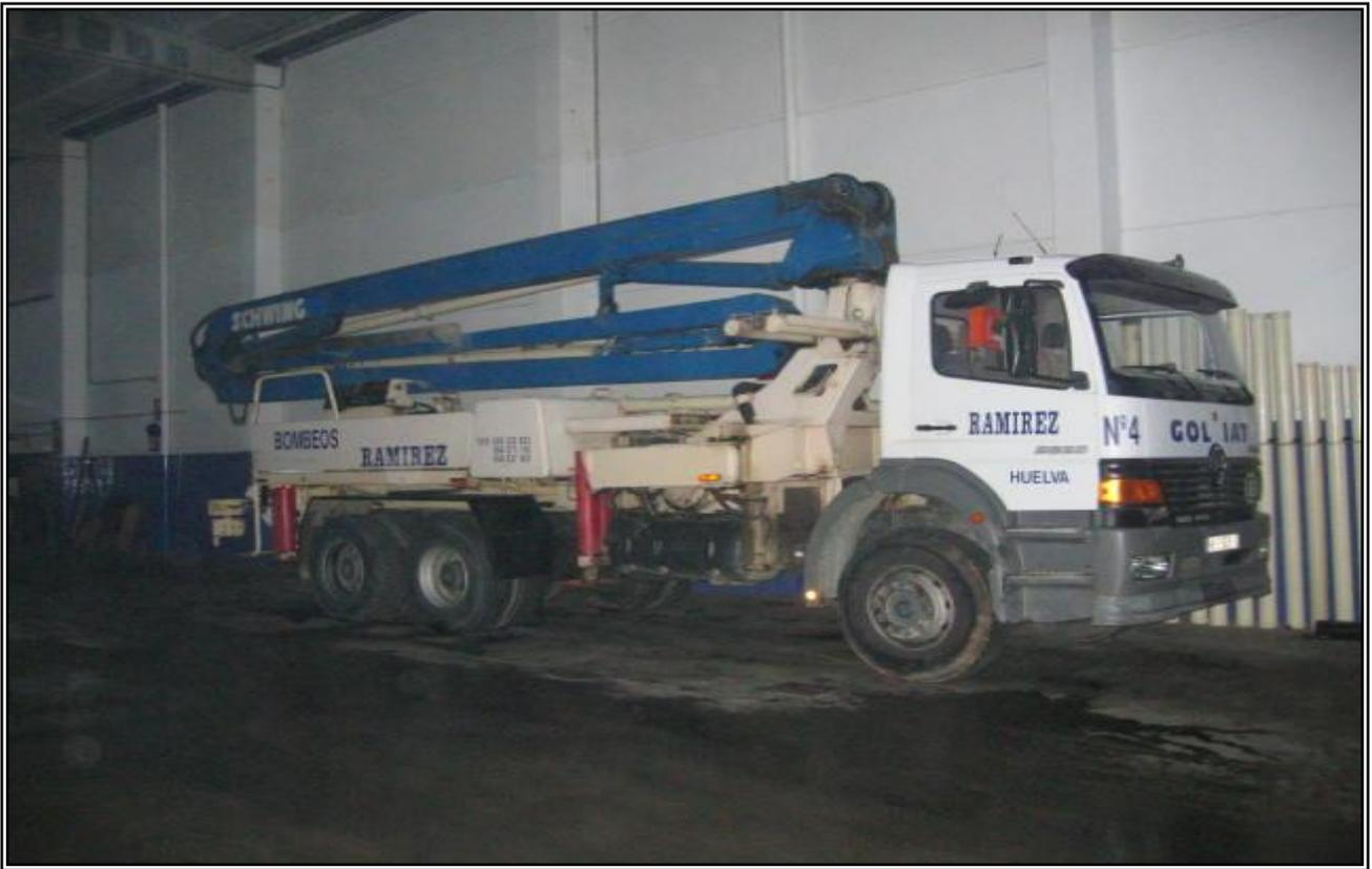
Autobomba de hormigonar marca Schwing modelo BPL-900-HDR-KVM 28, sobre camión Mercedes-Benz modelo 2628 con 280cv de potencia.
