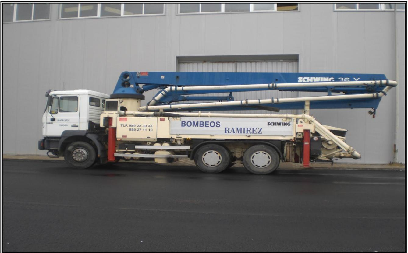
Autobomba de hormigonar marca Schwing modelo BPL 1200 HDRM KVM 34X, sobre camión Man modelo 27 314 con 310cv de potencia.
