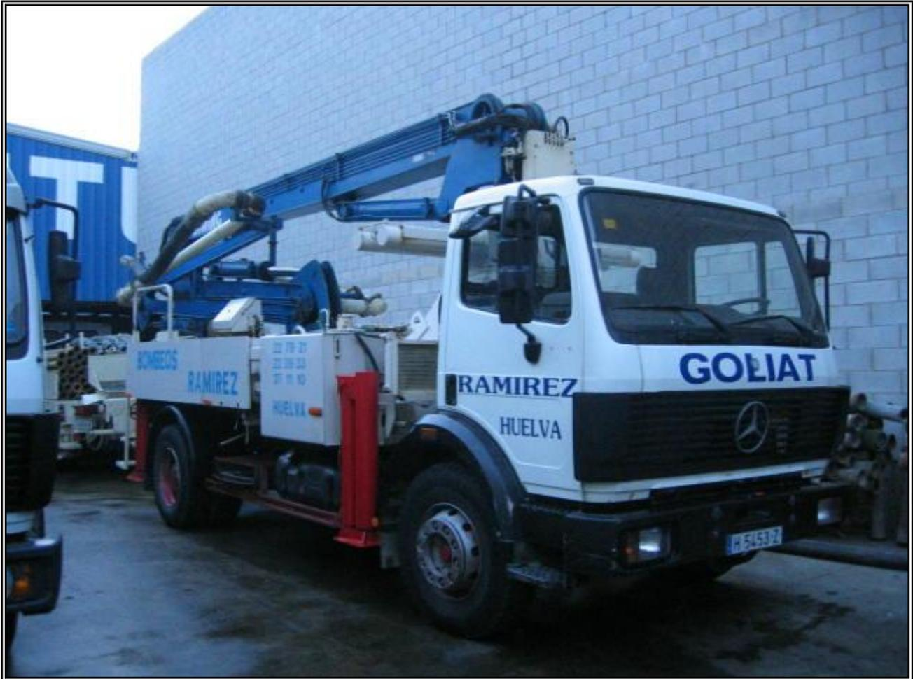
Autobomba de hormigonar marca Schwing modelo BPL-900-HDRM-KVM 23/4, sobre camión Mercedes-Benz modelo 1722 con 224cv de potencia.
