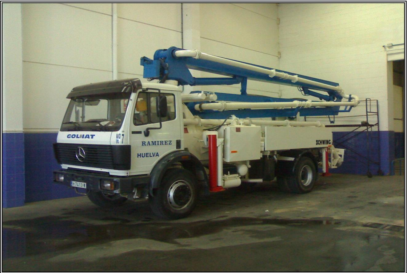
Autobomba de hormigonar marca Schwing modelo BPL-900-HDR-KVM 26, sobre camión Mercedes-Benz modelo 1722 con 224cv de potencia.
