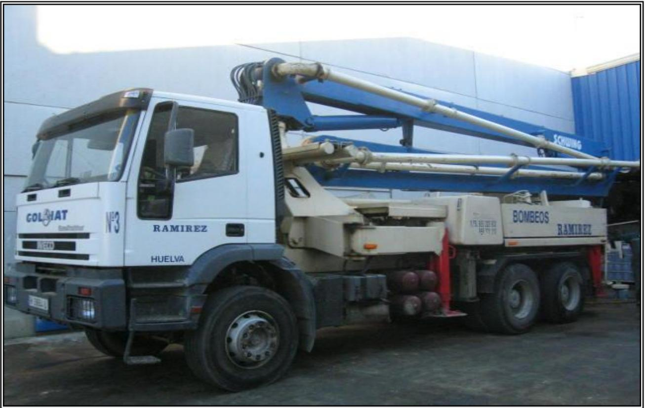
Autobomba de hormigonar marca Schwing modelo BPL-601-HD KVM 28, sobre camión Iveco modelo MP260E30H con 300cv de potencia.
