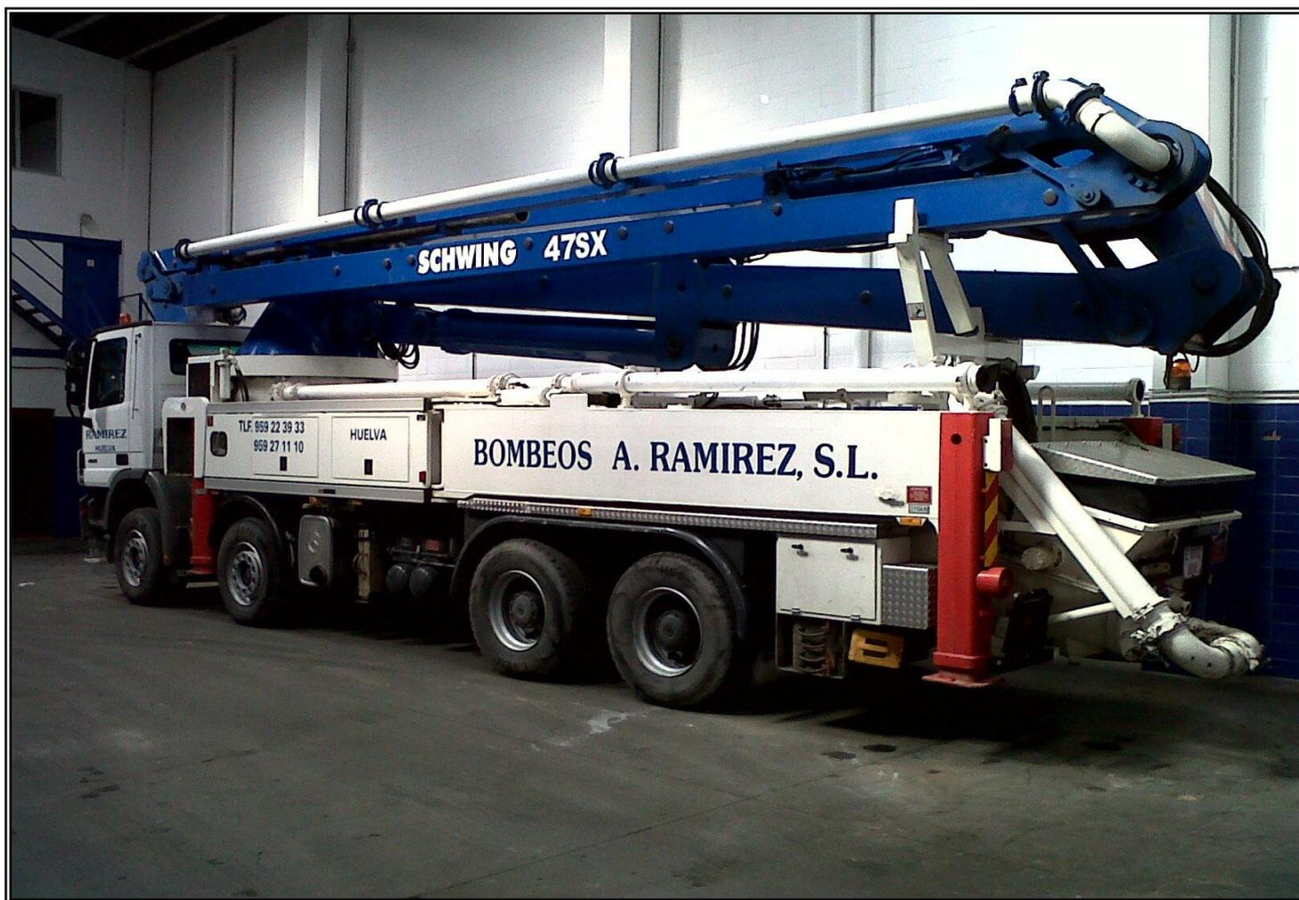
Autobomba de hormigonar marca Schwing modelo P-2023 HDRM-KVM 47SX, sobre camión Mercedes-Benz modelo 4141 con 407cv de potencia.
