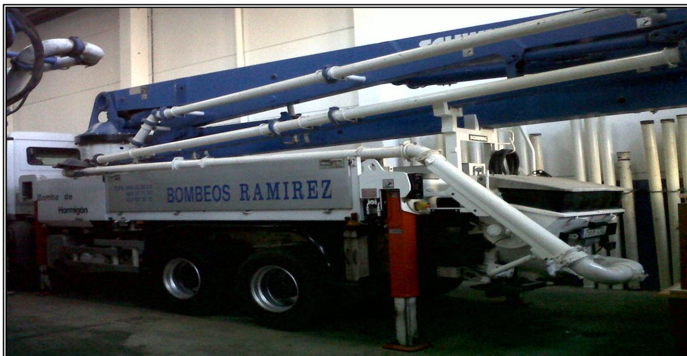
Autobomba de hormigonar marca Schwing modelo P-2020 H120/80-KVM 34X, sobre camión Mercedes-Benz modelo 3331 con 312cv de potencia.
