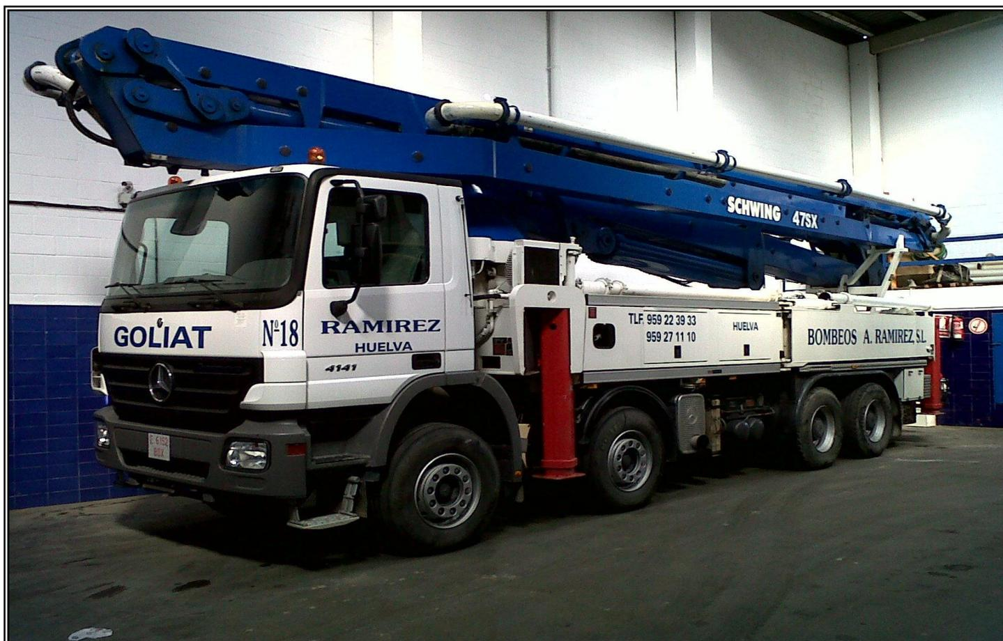
Autobomba de hormigonar marca Schwing modelo P-2023 HDRM-KVM 47SX, sobre camión Mercedes-Benz modelo 4141 con 404cv de potencia.
