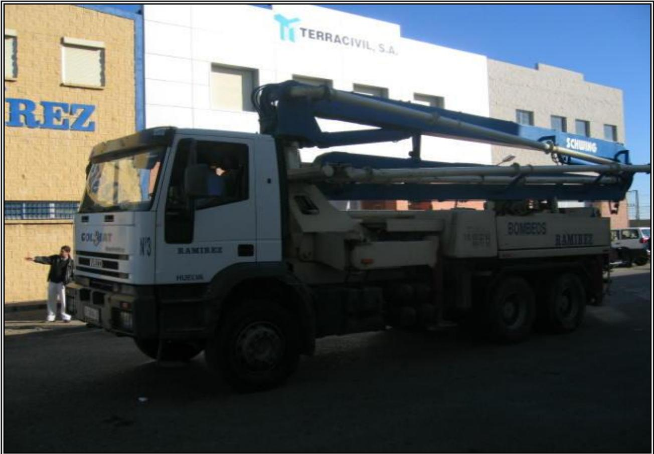
Autobomba de hormigonar marca Schwing modelo BPL-900-HDR-KVM 28, sobre camión Iveco modelo 1135 con 224cv de potencia.
