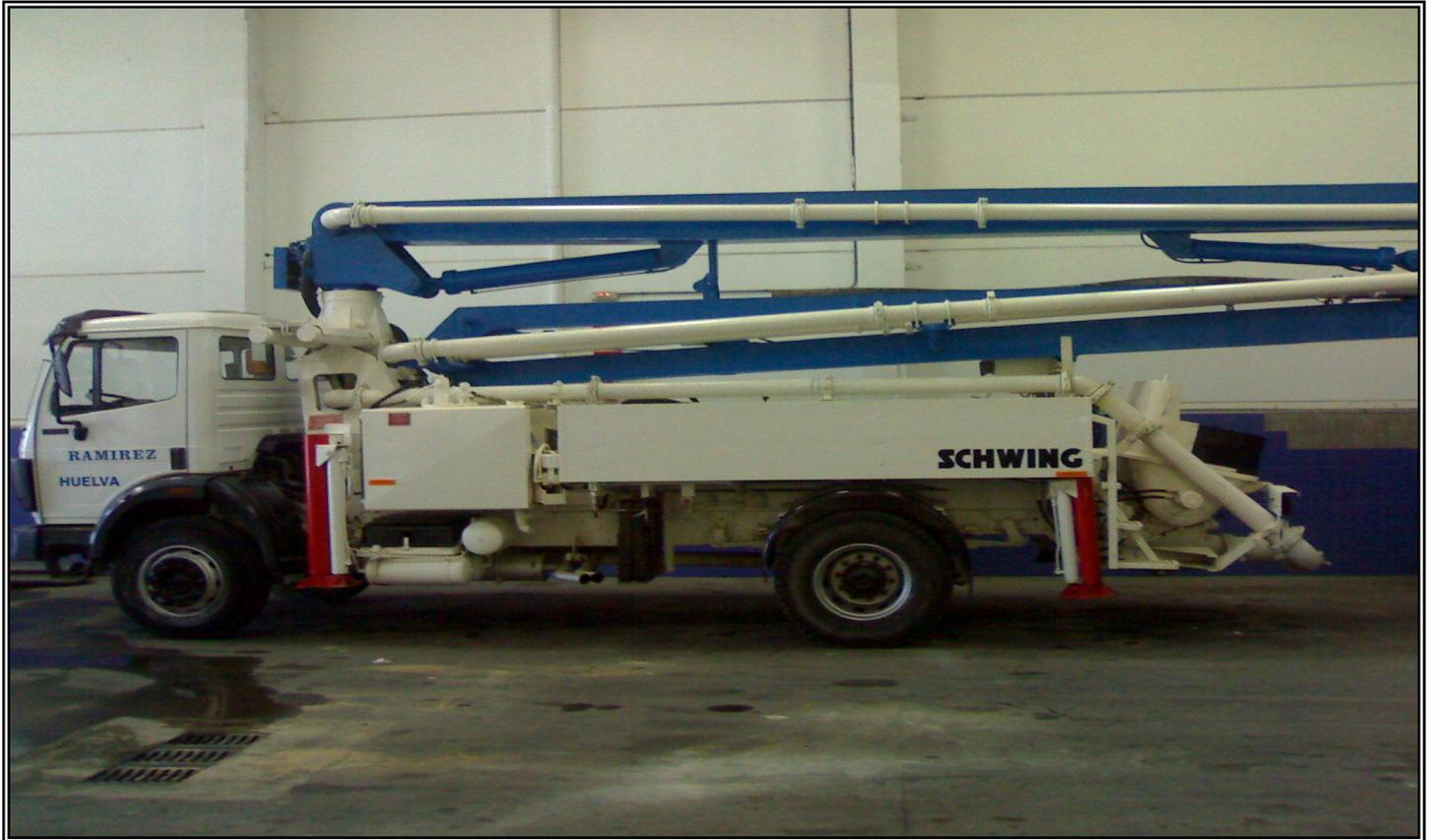
Autobomba de hormigonar marca Schwing modelo BPL-900-HDR-KVM 26, sobre camión Mercedes-Benz modelo 1722 con 224cv de potencia.
