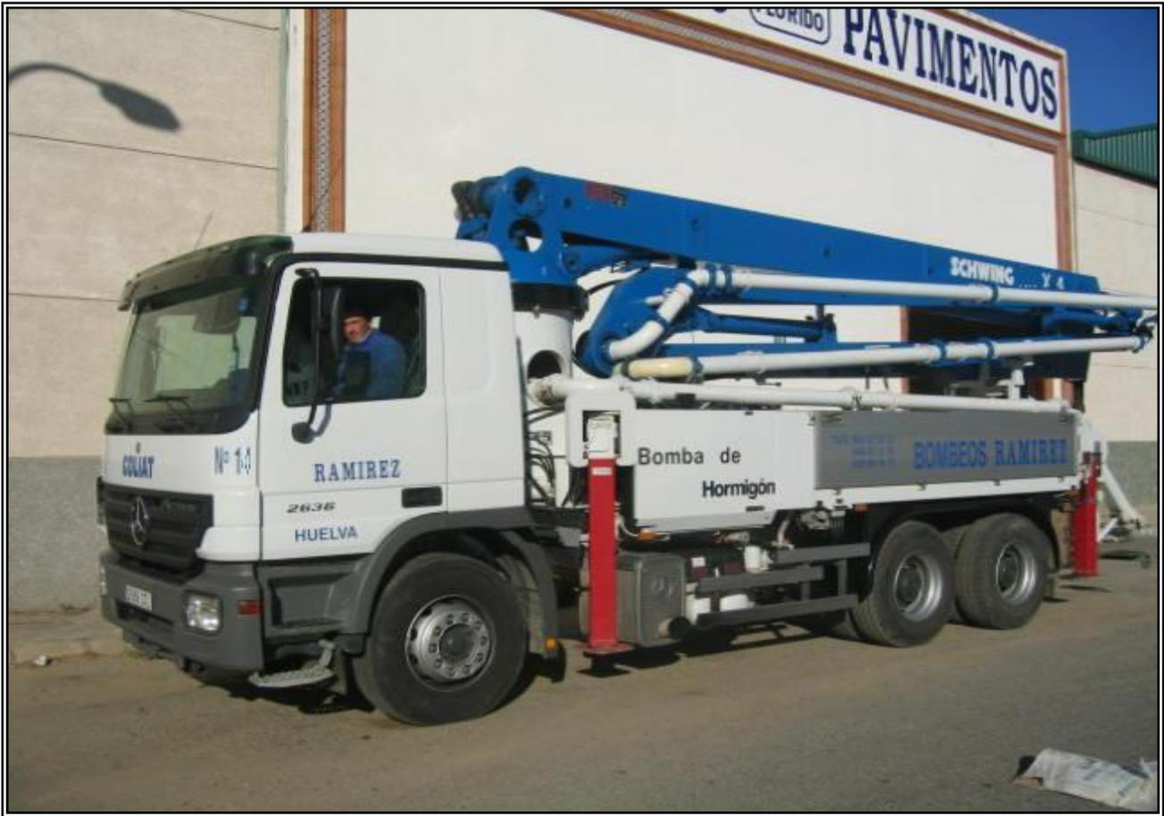
Autobomba de hormigonar marca Schwing modelo P-2023 HDRM KVM 34X, sobre camión Mercedes-Benz modelo 2636 con 360cv de potencia.
